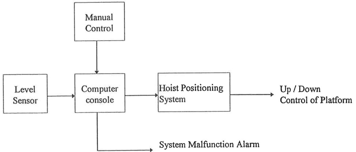
**SCHEMATIC OF LEVEL POSITIONING SYSTEM**
